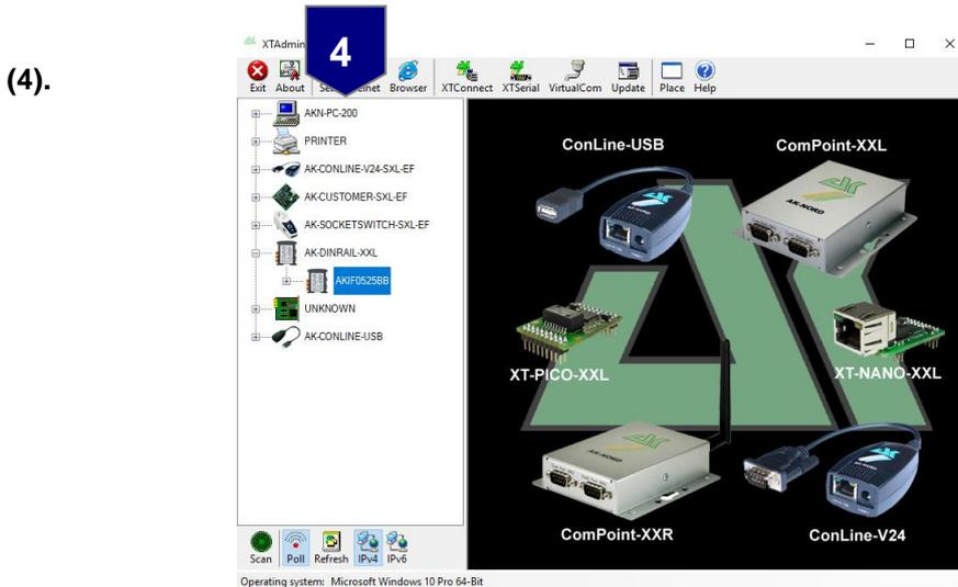
Wenn die Schnittstelle korrekt angewählt wurde, werden die Daten in das „Set IP“- Fenster übernommen. Achten Sie darauf, dass alle Felder ausgefüllt sind. Auch die grau hinterlegten Felder.
